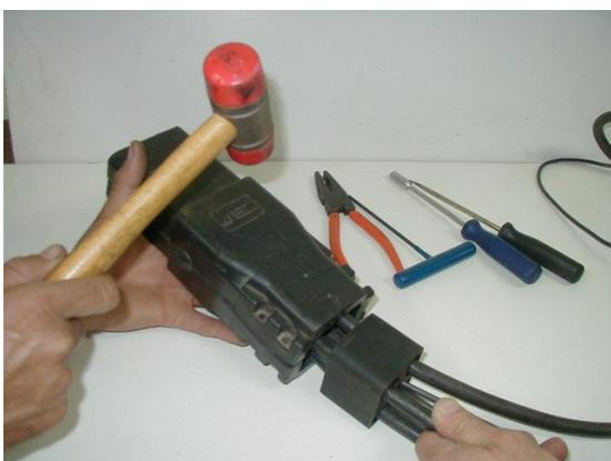
Bater firmemente com um martelo de poliuretano ou de borracha nas laterais, de um lado e do outro, para soltar os pinos dos cabos de saída dos encaixes cônicos nos 6 pinos, puxando os cabos.
