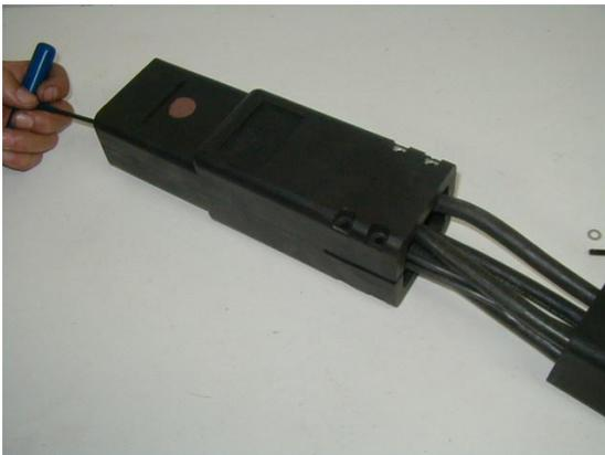
Coloque os cabos na borracha retangular com 5 furos (observe o lado mais largo p/ cima.), e encaixe cada um no seu pino correspondente na traseira. Confira a colocação dos cabos antes de montar os parafusos. Coloque os parafusos Allen. **Não inverter os cabos..** Aperte todos com firmeza. Coloque a borracha retangular para dentro e acerte-a na posição.
