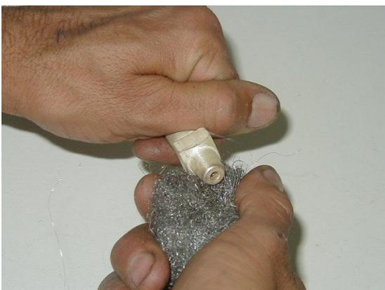
Lime as sobras de soldas ao redor dos pinos, e faça polimento com Bombril nas traseiras e frente cônica dos pinos, sem alterar a conicidade, que encaixa perfeitamente, com alta precisão.
