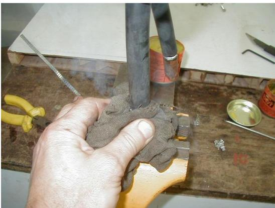
Esfriar imediatamente após a soldagem, com um pano molhado, sem abalar a solda.
